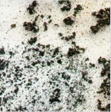
Schimmelsporen gibt es praktisch überall. Für Keimung und Wachstum werden ein geeigneter Nährboden und Feuchtigkeit benötigt. Da Schimmelpilze einen anpassungsfähigen Stoffwechsel haben, können einzelne Arten sich von Baustoffsubstraten ernähren.
